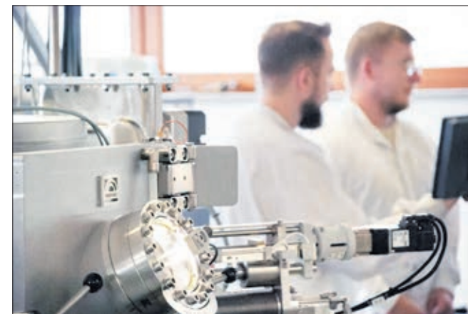
■ Montaż systemu PVD z projektu 602
