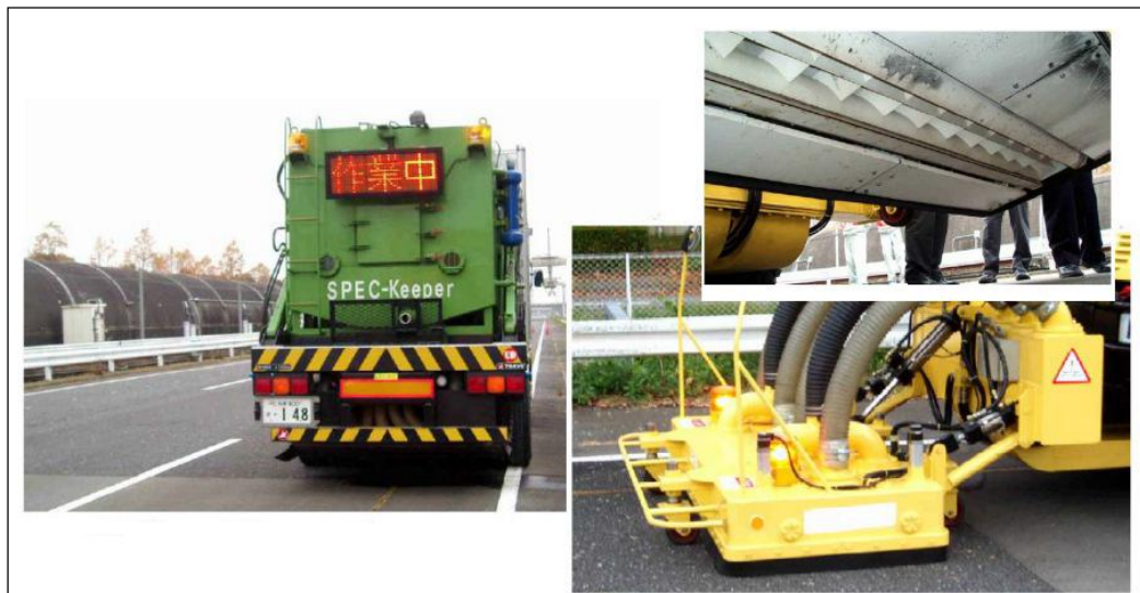
Rysunek 12. Sprzęt wykorzystywany przy oczyszczaniu nawierzchni z asfaltu porowatego [Źródło: Zastosowanie nowoczesnych technologii w konstrukcjach drogowych, Zakopane 15-17.09.2010 r.]
